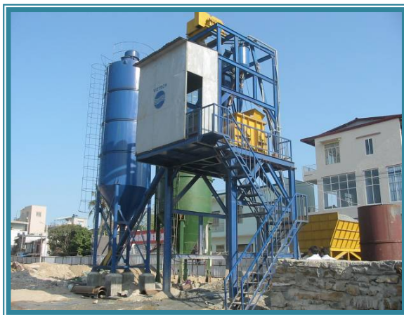
Trạm trộn BM60
